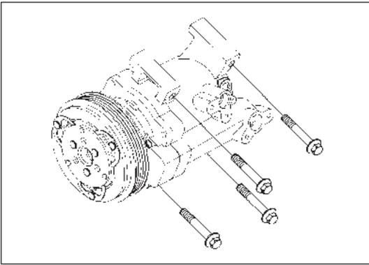
Рис. 6-4-5. Установка компрессора кондиционера
