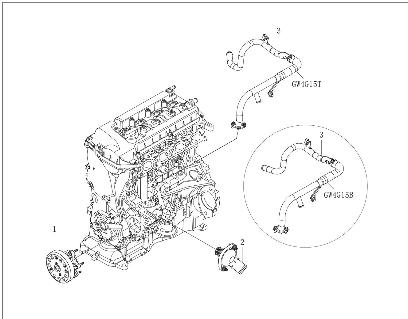
Рис. 10-1-1. Схема расположения компонентов системы охлаждения
