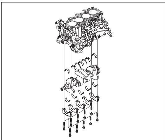
Рис. 13-3-18. Установка крышки коренного подшипника
