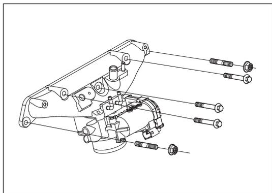
Рис. 8-2-6. Установка впускного коллектора (4G15T)
