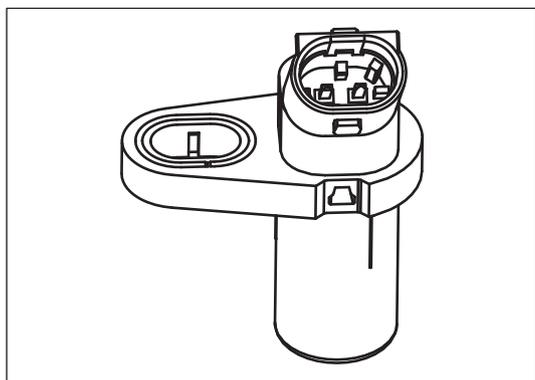
Рисунок 9-3-12. Датчик частоты вращения коленчатого вала
