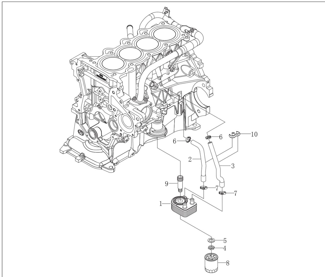
Рис. 10-3-1. Схема расположения деталей масляного радиатора
