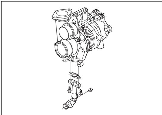
Рис. 7-2-4. Установка отводящей масляной трубки турбонагнетателя
