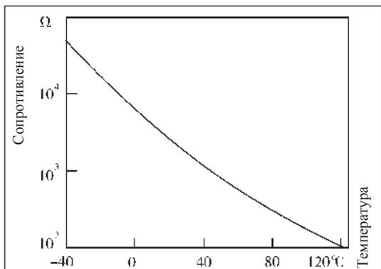
Рис. 9-3-19. Характеристическая кривая датчика температуры ОЖ
