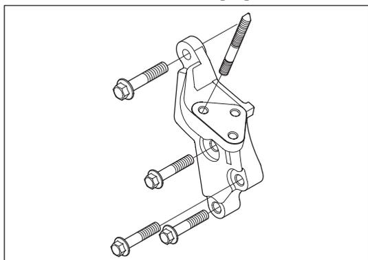
Рис. 6-4-4. Установка передней опоры двигателя
