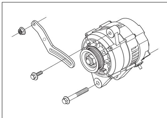
Рис. 6-2-1. Разборка крепления генератора
