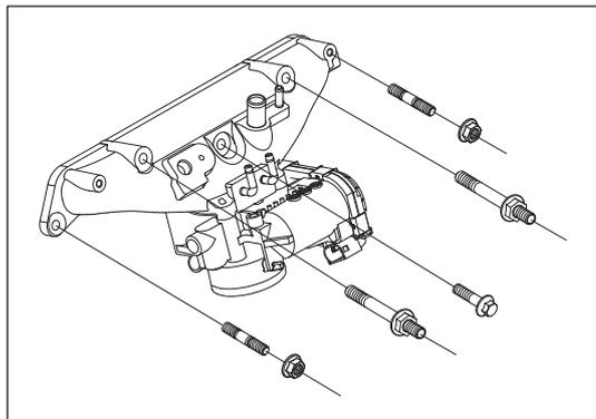
Рис. 8-2-7. Установка впускного коллектора (4G15B)
