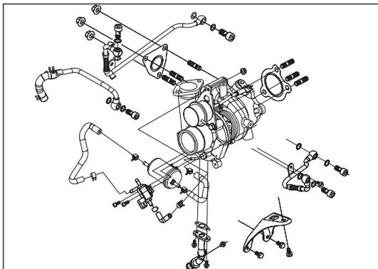
Рис. 7-2-2. Снятие компонентов турбоагнетателя
