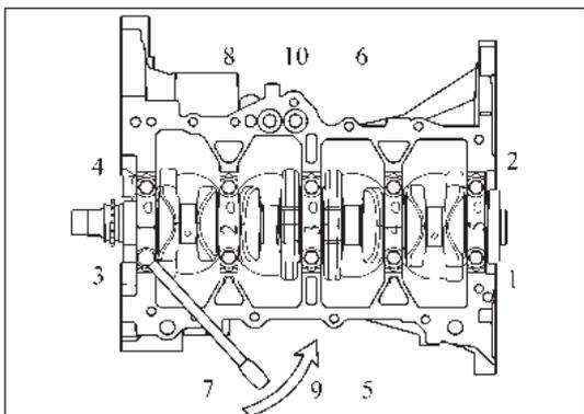
Рис. 13-3-4. Порядок снятия болтов коренных подшипников
