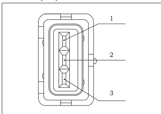
Рисунок 9-3-9. Контакты датчика положения
