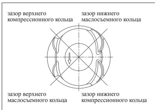
Рис. 13-2-11. Положение зазора поршневых колец
