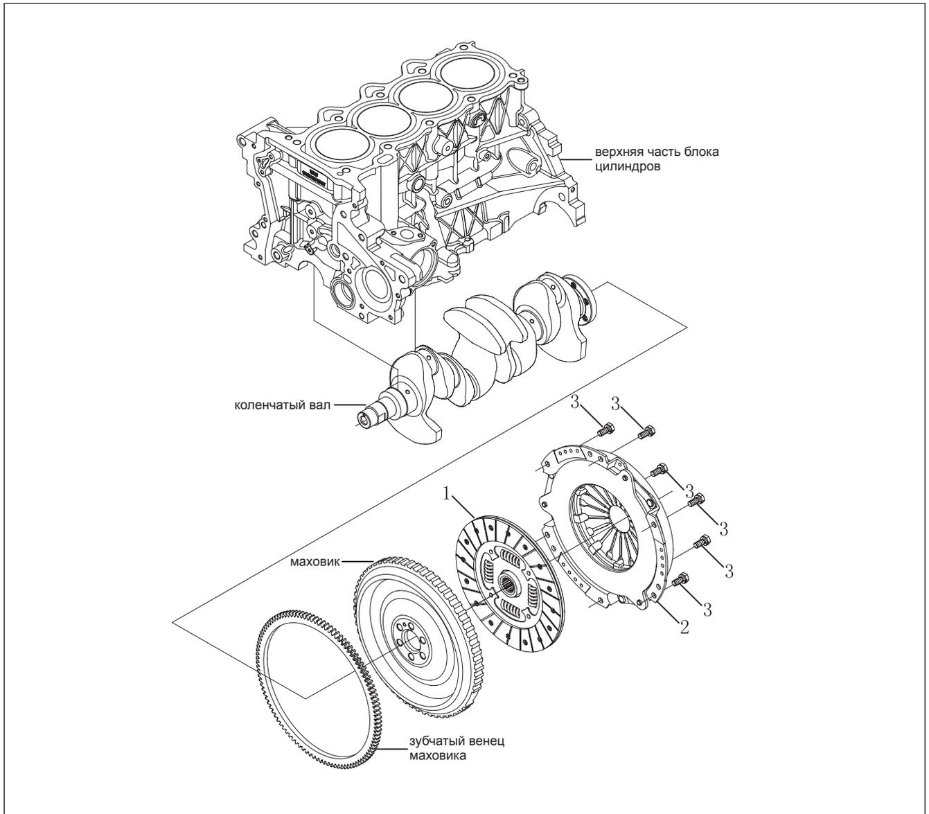
Рис. 14-1-1. Схема расположения компонентов сцепления
