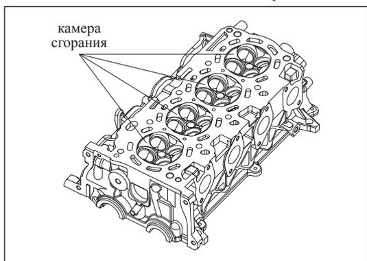
Рис. 12-3-8. Удаление нагара из камеры сгорания
