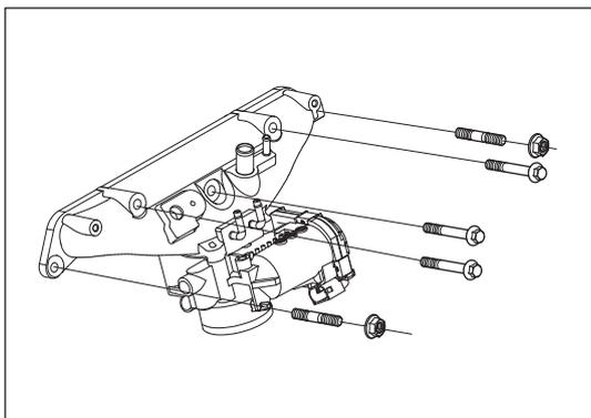
Рис. 8-2-2. Снятие впускного коллектора (4G15T)
