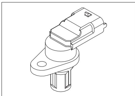
Рисунок 9-3-8. Датчик положения распределительного вала
