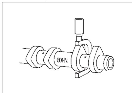
Рис. 12-3-25. Измерение высоты кулачков
