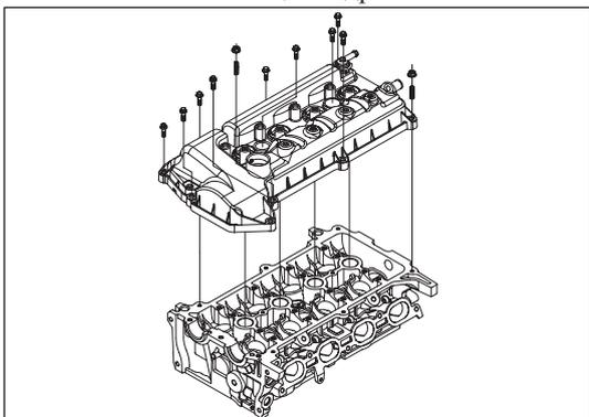
Рис. 12-2-7. Установка крышки головки блока цилиндров
