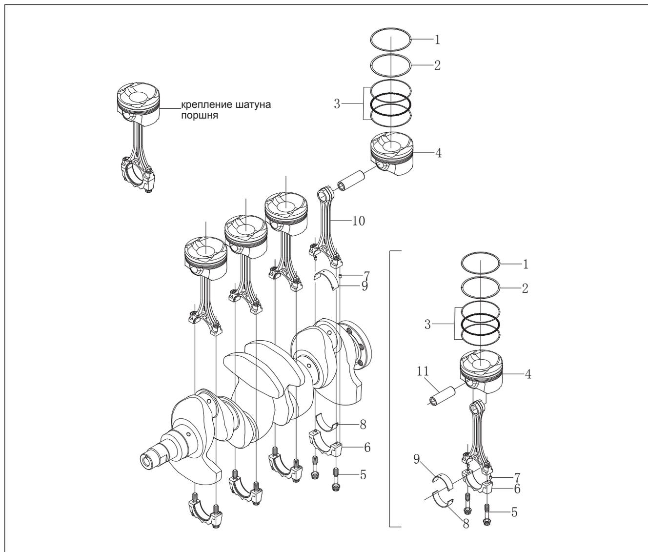
Рис. 13-2-1. Схема крепления компонентов шатуна поршня
