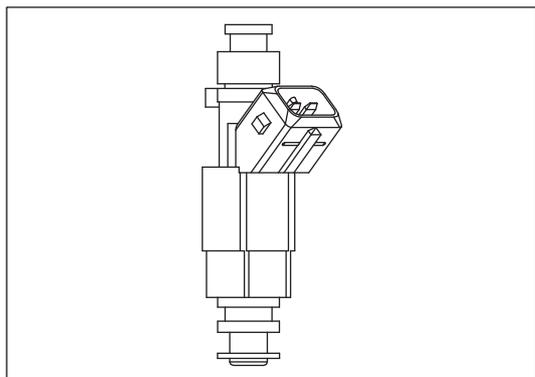
Рисунок 9-3-5. Электромагнитная топливная форсунка
