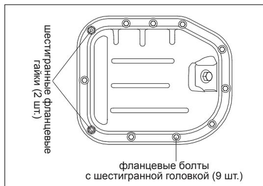
Рис. 11-3-8. Установка масляного поддона
