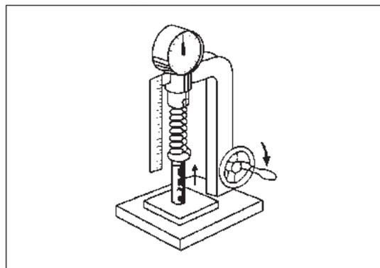
Рис. 12-3-24. Измерение давления пружины клапана в установленном состоянии
