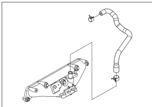
Рис. 6-4-3. Снятие шланга принудительной вентиляции картера
