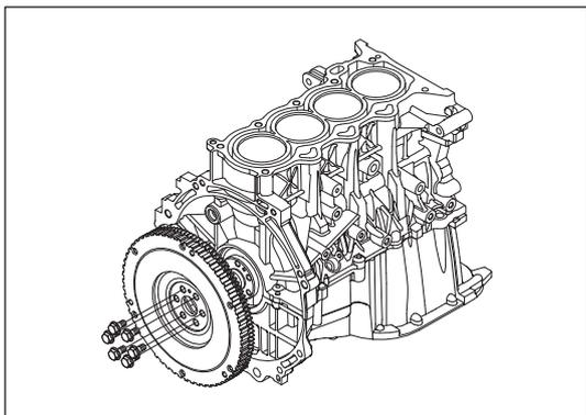
Рис. 13-3-3. Снятие маховика
