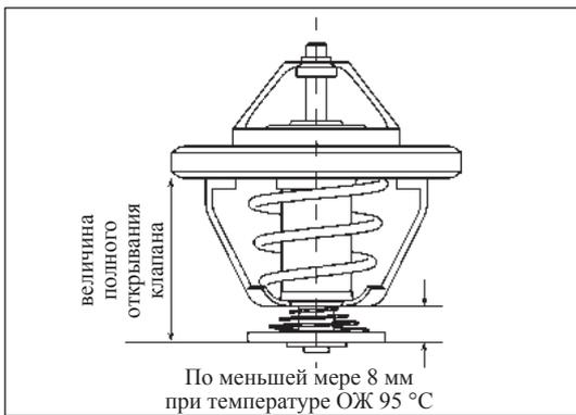
Рис. 10-5-6. Проверка открывания клапана термостата
