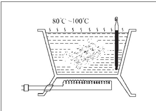
Рис. 12-3-32. Нагрев головки цилиндров
