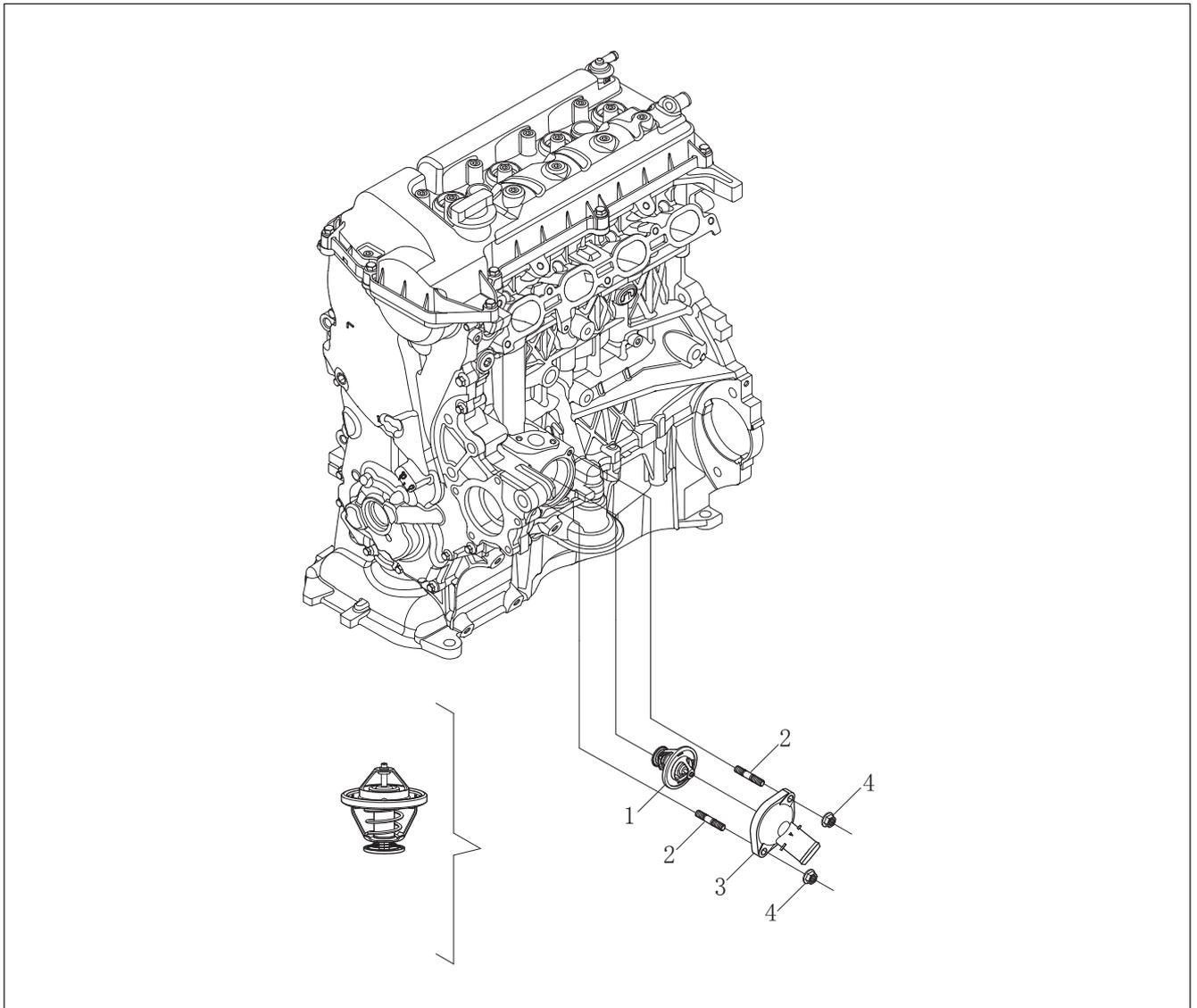
Рис. 10-5-1. Схема расположения компонентов термостата
