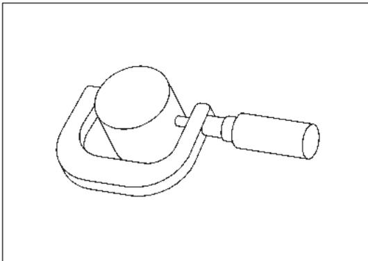
Рис. 12-3-31. Измерение диаметра толкателя клапана
