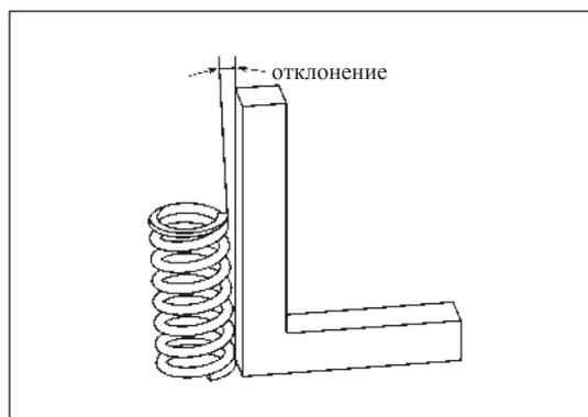
Рис. 12-3-22. Измерение перпендикулярности пружины клапана
