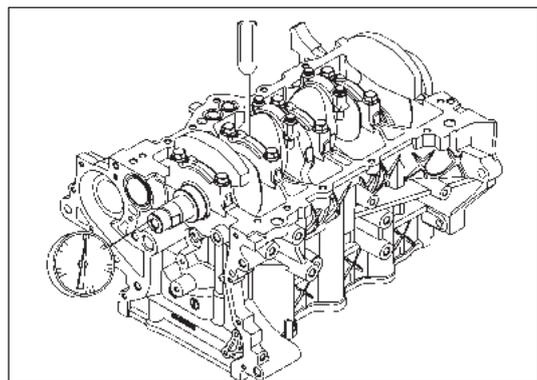
Рис. 13-3-16. Измерение осевого зазора коленчатого вала
