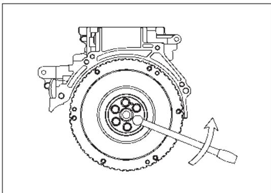
Рис. 13-3-2. Снятие болта маховика
