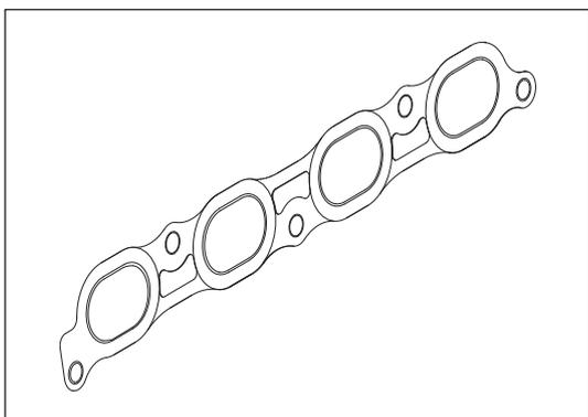
Рис. 8-2-5. Прокладка впускного коллектора
