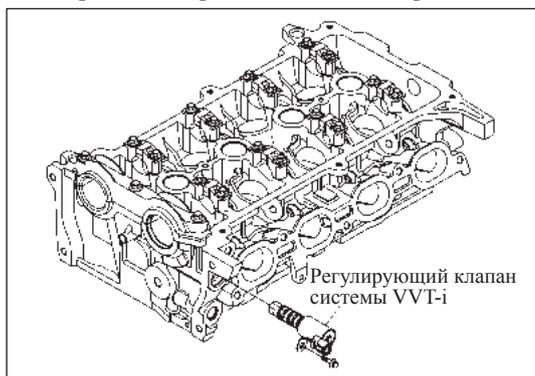
Рис. 12-3-49. Установка регулирующего клапана системы VVT-i
