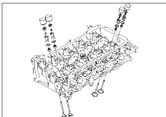
Рис. 12-3-38. Установка толкателя клапана
