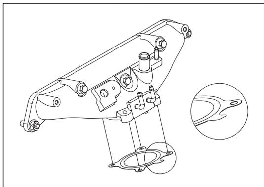
Рис. 8-2-8. Установка прокладки дроссельной заслонки
