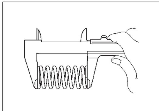
Рис. 12-3-23. Измерение свободной длины пружины клапана
