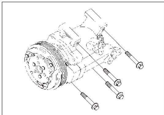
Рис. 6-4-2. Снятие компрессора кондиционера
