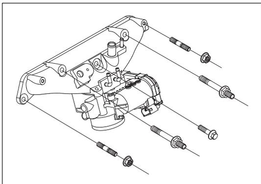
Рис. 8-2-3. Снятие впускного коллектора (4G15B)
