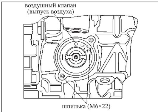
Рис. 10-5-7. Установка термостата
