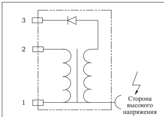
Рис. 9-3-25. Электрическая схема катушки зажигания
