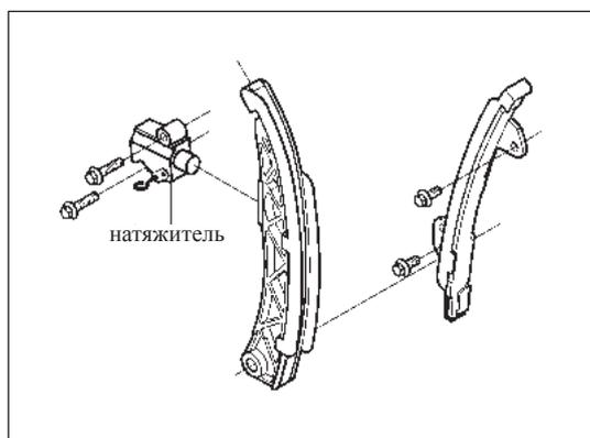
Рис. 12-4-11. Установка натяжителя
