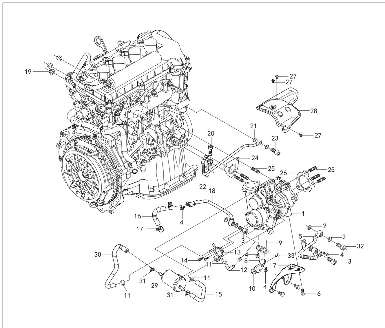
Рис. 7-1-1. Схема расположения компонентов турбонагнетателя
