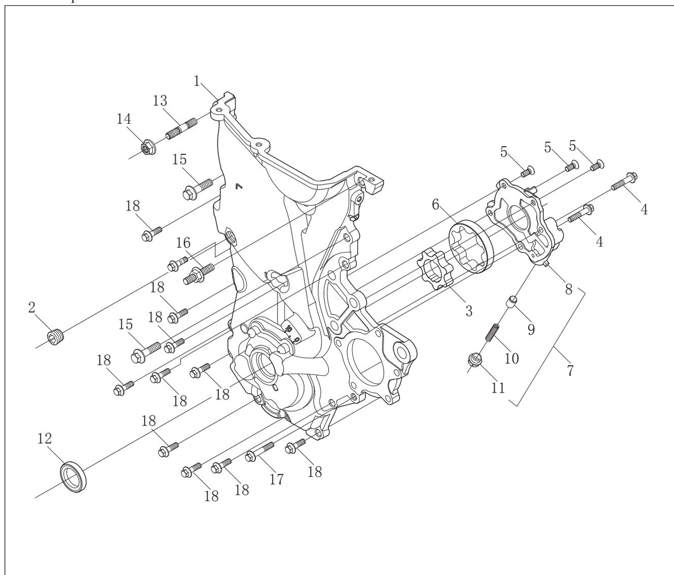
Рис. 11-4-1. Схема компонентов масляного насоса
