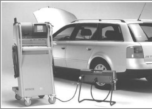
Рис. 9-1-5. Анализатор отработавших газов
