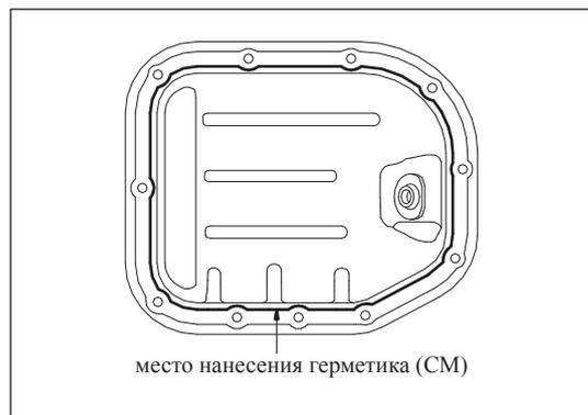
Рис. 11-3-7. Нанесение герметика
