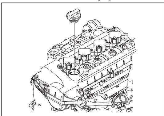
Рис. 12-2-9. Установка крышки заливной горловины
