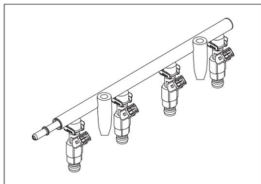
Рисунок 9-3-4. Топливная рампа
