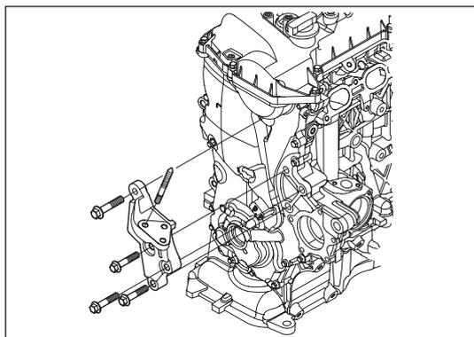
Рис. 6-4-1. Снятие передней опоры двигателя
