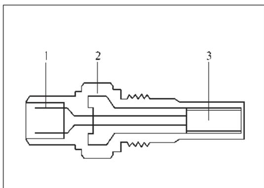
Рис. 9-3-18. Датчик температуры ОЖ в разрезе
