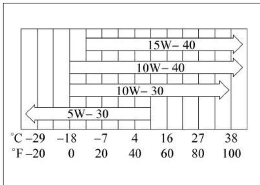
Рис. 11-2-1. Рекомендуемые марки масла в зависимости от температуры окружающей среды
