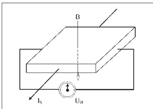
Рисунок 9-3-10. Принципиальная схема работы датчика Холла
