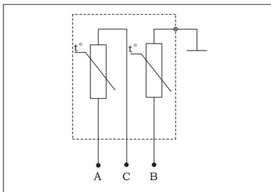
Рис. 9-3-17. Схема датчика температуры ОЖ
