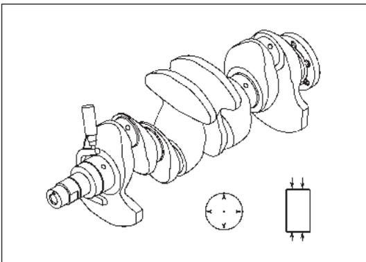
Рис. 13-3-12. Измерение диаметра шейки коленчатого вала
