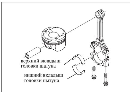
Рис. 13-2-12. Установка шатунов и вкладышей
