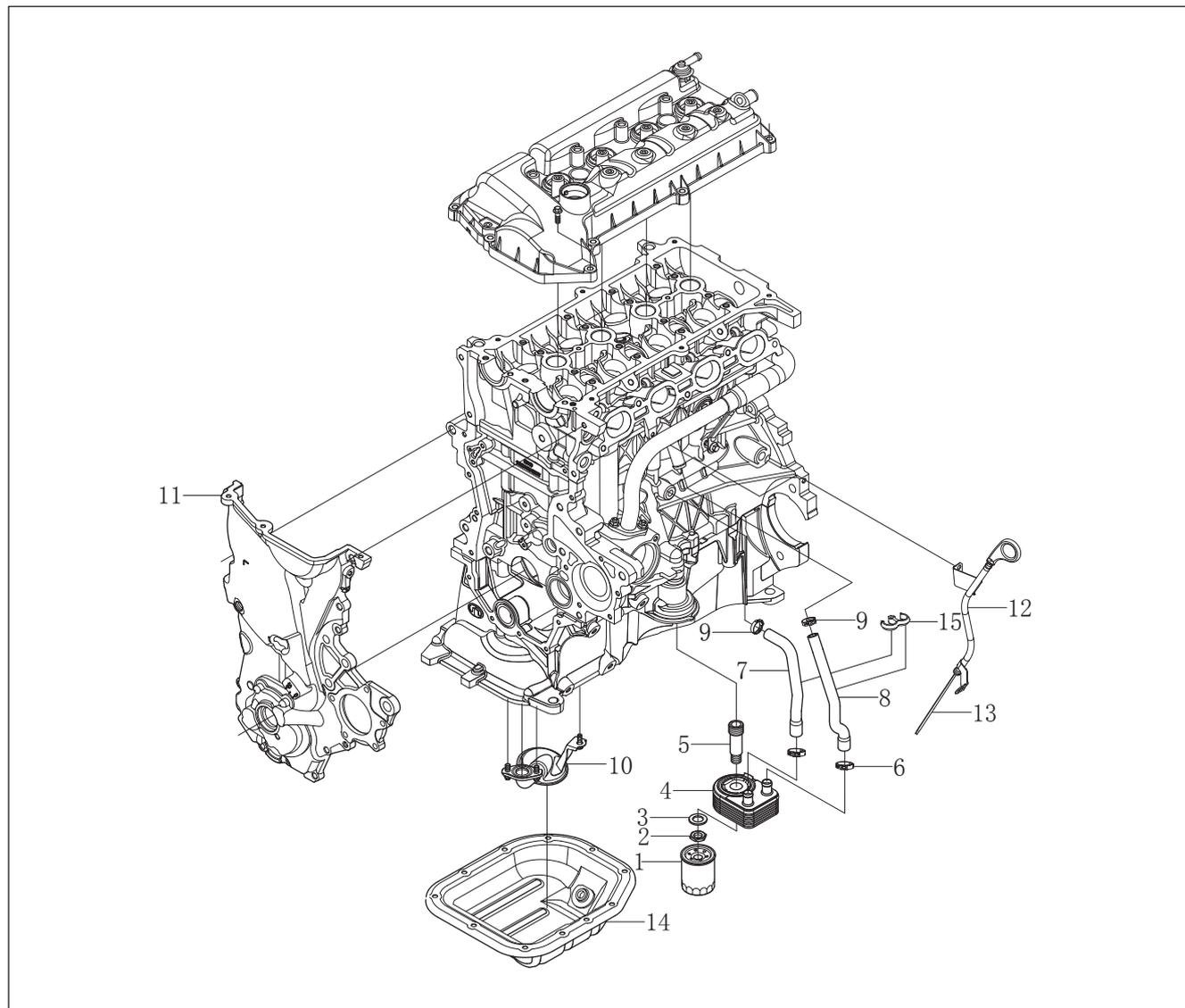
Рис. 11-1-1. Схема крепления компонентов системы смазки
