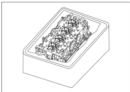
Рис. 12-3-9. Чистка головки блока цилиндров
