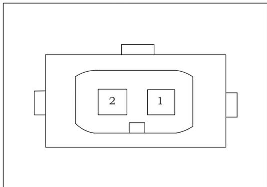
Рисунок 9-3-6. Назначение контактов топливной форсунки
