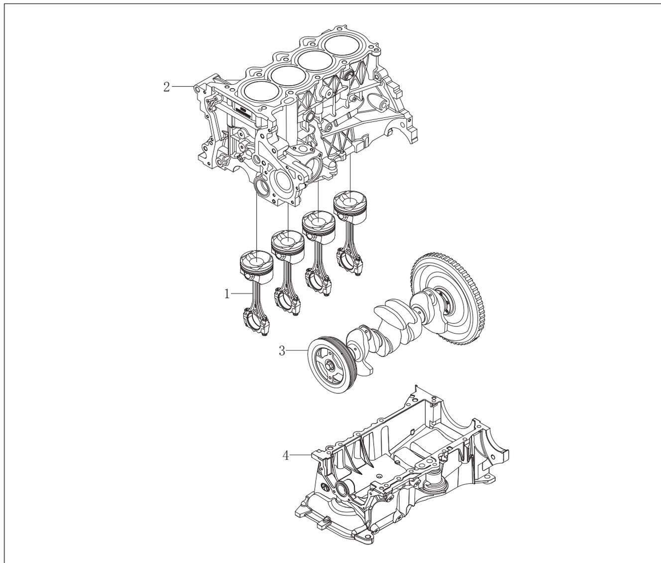
Рис. 13-1-1. Схема расположения компонентов блока цилиндров
