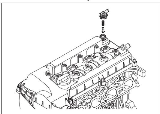
Рис. 12-2-8. Установка системы принудительной вентиляции картера
