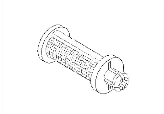
Рис. 12-3-47. Проверка сетчатого фильтра
