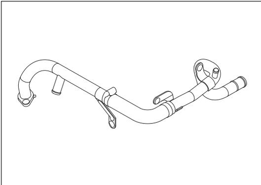
Рис. 10-6-4. Проверка отводящей трубы нагретой ОЖ
